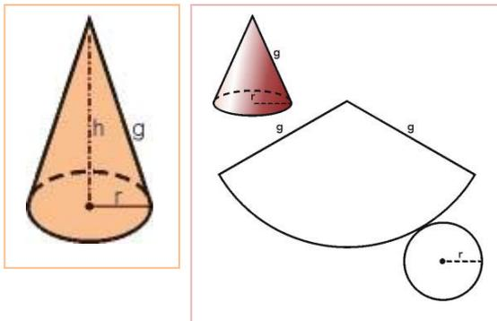
Un **cono** se puede generar haciendo girar un triángulo rectángulo alrededor de uno de sus catetos. El círculo que se obtiene al girar el otro cateto es la *base* del cono. El lado del triángulo que nos sirve como eje de giro coincide con la *altura* del cono. La hipotenusa del triángulo rectángulo mide lo mismo que la *generatriz* del cono.
