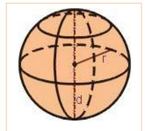
Cuando cortamos una esfera por un plano, todos los cortes son círculos. Si el plano por el que cortamos pasa por el centro de la esfera, obtenemos un **círculo máximo**. Su radio es igual al de la esfera.
