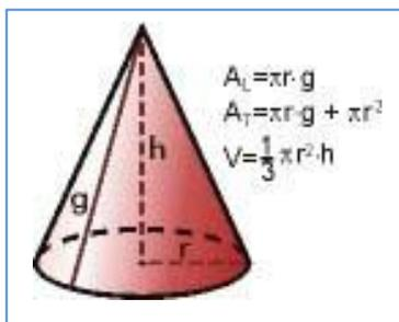
El volumen de un cono equivale a un tercio del volumen del cilindro que tiene la misma base y la misma altura. Así, para un cono cuyo radio de la base es  $r$  y su altura es  $h$  se tiene que
