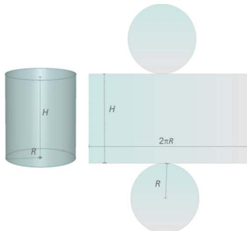
Supondremos que la altura del cilindro es  $H$  y que  $R$  es el radio de la base con lo que el área lateral  $A_L$  es:
