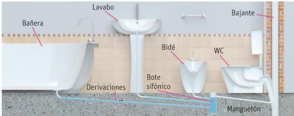
Fig.-4.5. Bote sifónico. (Fuente: desconocida)
