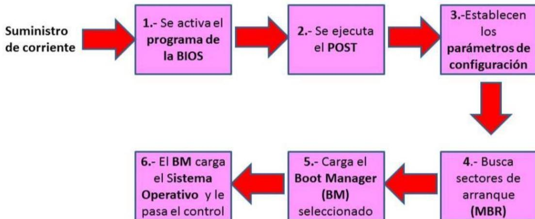
Fig.-2.3 Secuencia de arranque de un ordenador (Fuente: propia)
