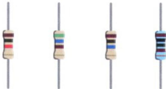
**Resistencias** - Se opone al paso de la corriente eléctrica en un circuito, dando como resultado a un cambio en la tensión y en dicha corriente. El valor de las resistencias se mide en ohmios (se representa por la letra griega omega:  $\Omega$ ). Las bandas de colores en un lado de la resistencia indica su valor
