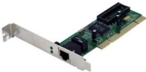
Fig.-1.19 Adaptador Ethernet interno
