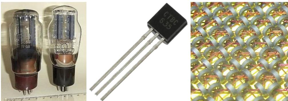
Fig.-0.1 Válvulas de vacío, transistor y memoria de ferritas (Fuente: Wikipedia y Flickr)
