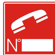
Teléfono de emergencia para incendios
